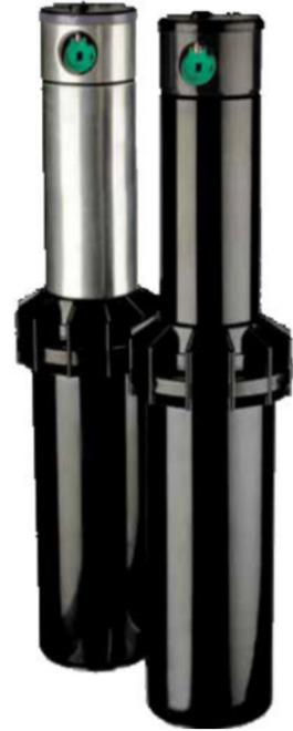
L'arroseur ProSport™ est fourni de série avec trois buses: une buse principale adaptée à une longue distance et deux buses secondaires pour des distances moyennes et courtes. Cette configuration des buses permet d'obtenir une distribution homogène de l'eau, de 13 à 23 m de distance.
