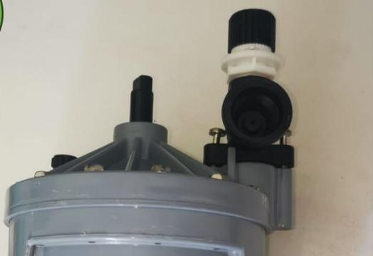
Fixer l'adaptateur Omnireg à la place de l'adaptateur et utiliser les vis pour le fixer.
