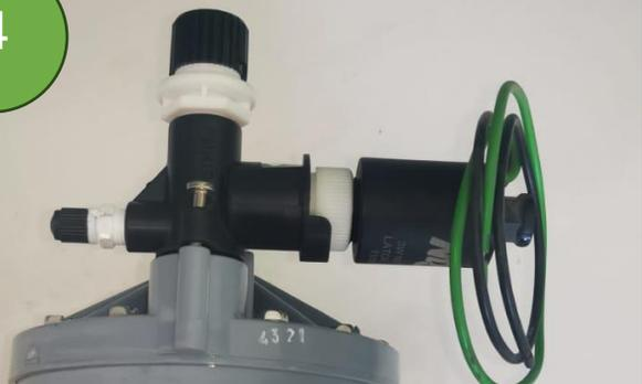
Visser le solénoïde dans l'adaptateur sur le côté du régulateur Omnireg.
