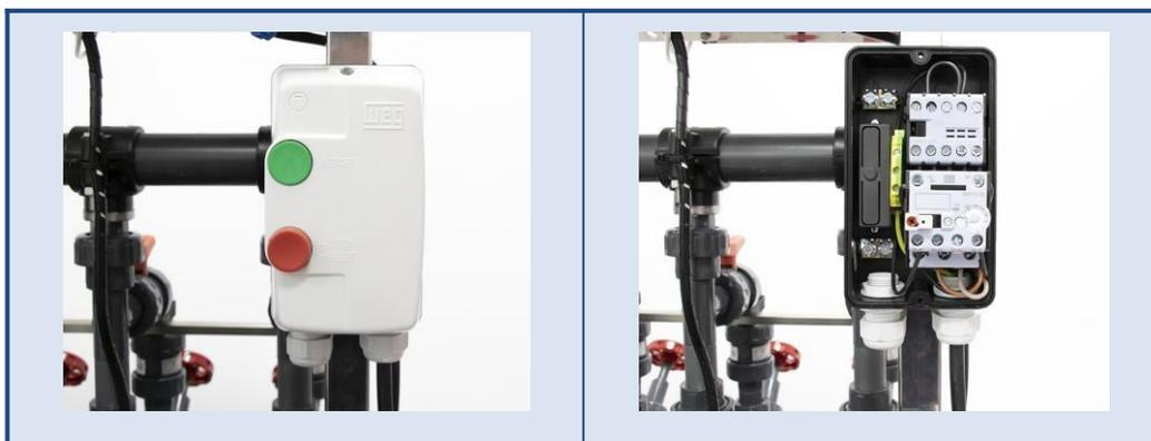
Figure 2. Boîtier de démarrage manuel.
