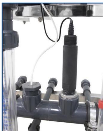
Figure 10. Collecteur de capteurs avec capteur de pH et capteur EC/température.
