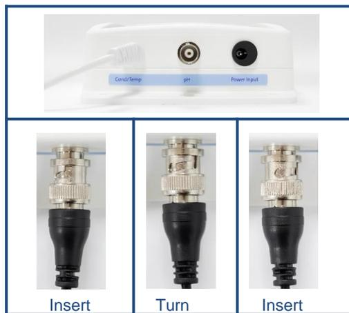
Figure 11. Connexion du capteur au contrôleur ARGOS.
