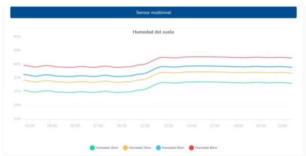
Courbes représentatives des résultats d'une sonde capacitive à différentes profondeurs.
