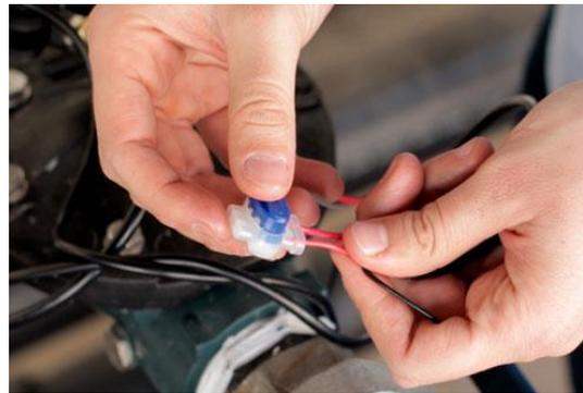
figure 6 Connexion de polarité positive par un connecteur scellé.
